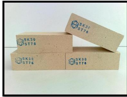
อิฐทนไฟเกรด SK 30 อยู่ชั้นในเตา ทนอุณหภูมิได้ 1,300 องศาเซลเซียส
