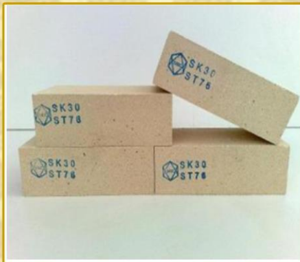
อิฐทนไฟเกรด SK 30 อยู่ชั้นในเตา ทนอุณหภูมิได้ 1,300 องศาเซลเซียส
